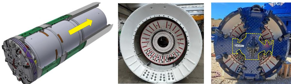
**Figura 2. Macchina retraibile: schema (sin); inserimento del primo elemento nel guscio (centro); testa fresante con identificazione della parte centrale solidale al primo elemento (dx)**
